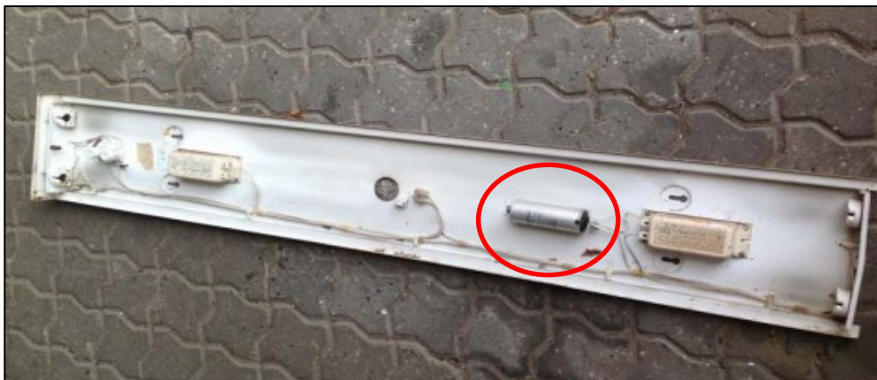
Lysstofarmatur med kondensator (rød cirkel)
