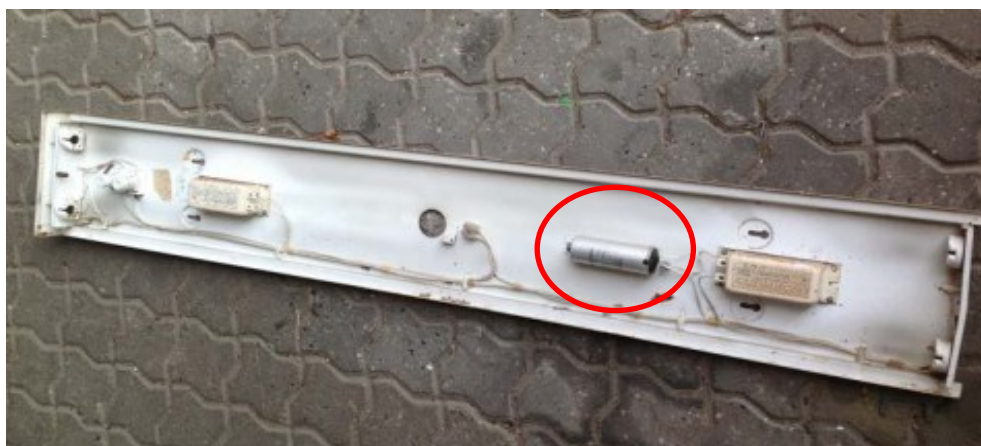
Lysstofarmatur med kondensator (rød cirkel)
